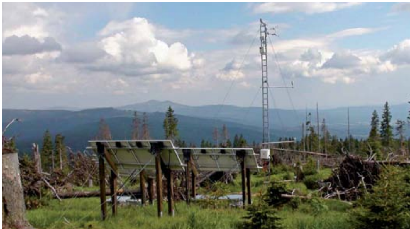
Messanlage zur automatischen Aufzeichnung von meteorologischen und olfaktorischen Daten (Foto: Heiner Rall)
